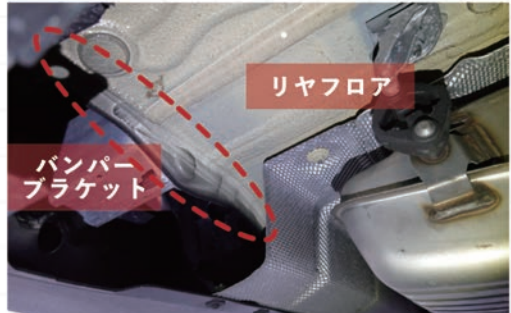
画像⑥ リヤフロア全体に塗布された耐チッピング塗装も状態見極めのヒント (画像は新車状態)
