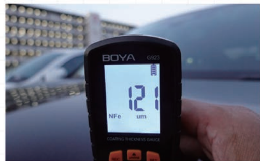
画像② アルミ合金と鋼板による大きな相違は無し (画像はボンネット測定)
