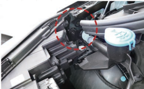
画像⑤ フェンダー取付部分でもある先端部は損傷リスク大 (画像は新車状態)
